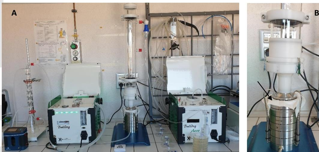
Figura 2 – A) Sistema per l'esecuzione del test. B) Particolare del campionatore multistadio con provino inserito (freccia)
